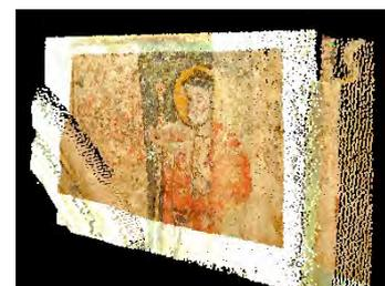
L'exploitation finale du nuage de points afin d'extraire des coupes, des cotes ou des coordonnées de point est effectuée sous AutoCad à l'aide de l'application CloudWorx. Avec cet applicatif, des parties du nuage peuvent être isolées et des sections horizontales ou verticales choisies.
