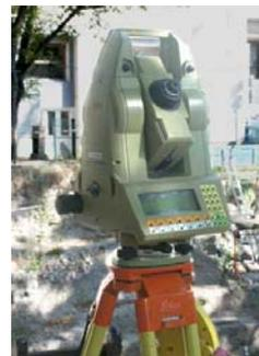
On obtient, grâce au relevé topographique, un tableau présentant, pour chaque point d'amer, les coordonnées x, y et z ainsi que le numéro du fait ou du mur relevé.
